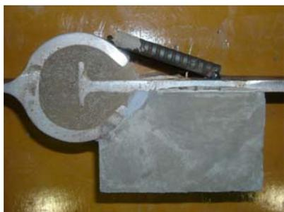
図-参6.7 継手状況 (CASE-d)
